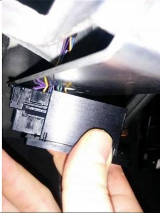
OBD-Buchse in unteres Gehäuseteil des OBD-Saver schieben
